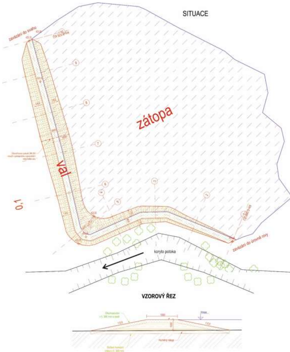
Obr. Vzorový řez retenčního valu typu hokejka.
